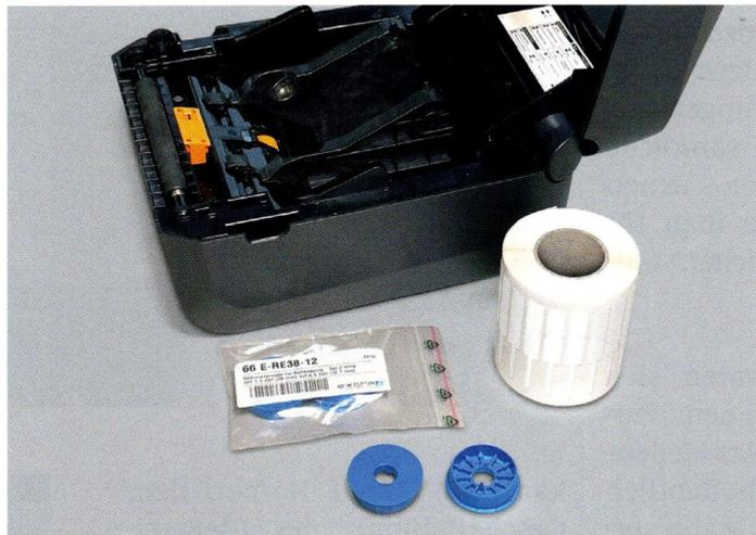
*Der neue Rollenkernel-Adapter von extra4 Labelling Systems verbessert die Druckpräzision von Thermo-transfer-Druckern*
